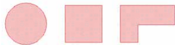
3 figuren met dezelfde oppervlakte. De cirkel is de meest compacte vorm en heeft het kleinste verliesoppervlakte. De derde figuur heeft in verhouding een grotere (te isoleren) buitenomtrek. Bron: VIBE
